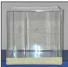
Ce type de moule existe aussi en version carrée et s'utilise différemment; chacune des quatre parois est coulée individuellement. Il faut simplement délimiter la largeur du bord avec du ruban adhésif (ruban de masquage écru) et placer le moule bien à plat, l'ouverture face à vous (et non pas contre le plafond). Une fois la première paroi durcie, tournez le moule d'un quart de tour et coulez la seconde paroi, etc..
